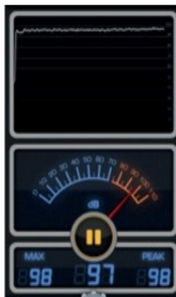
Fig. 2- Ruído medido no aplicativo sem o caminhão reabastecimento acoplado à aeronave.
